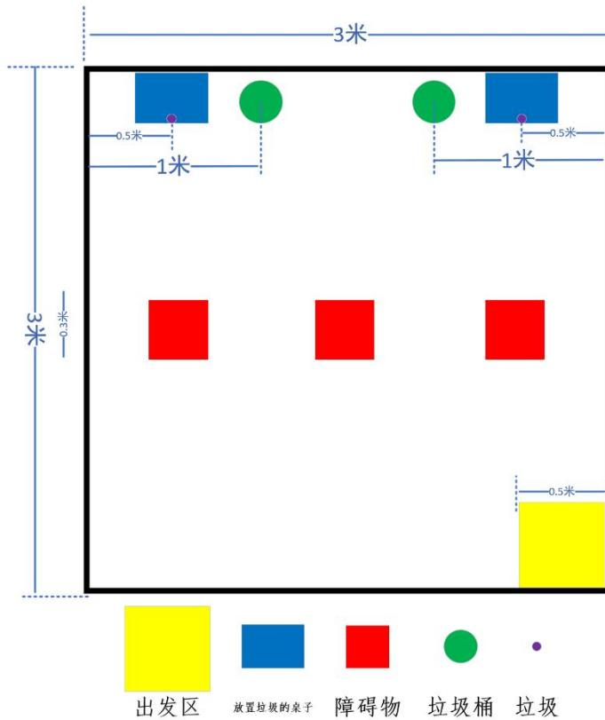
1) 比赛场地为  $3m \times 3m$  的正方形场地，赛场将使用隔离板隔离，隔离板高度为 0.4m。场地地面及隔离板颜色为白色，出发区的尺寸为  $0.5 \times 0.5m$ 。
