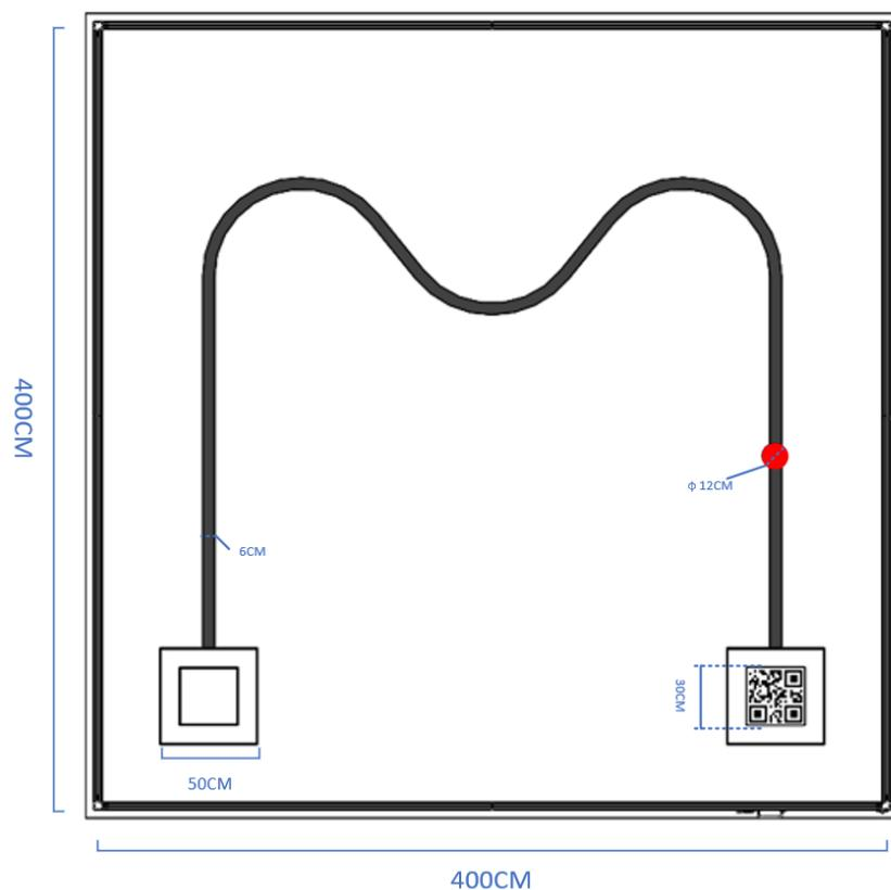
如上图所示，比赛场地尺寸为长4米、宽4米、高2.5米，场地出发区和降落区的尺寸为50\*50CM，降落标志的直径为12CM，圆心距离降落区外围的长度为80CM，二维码尺寸为30\*30CM，黑色线宽为6CM，场地四周及顶部布置有安全网。
