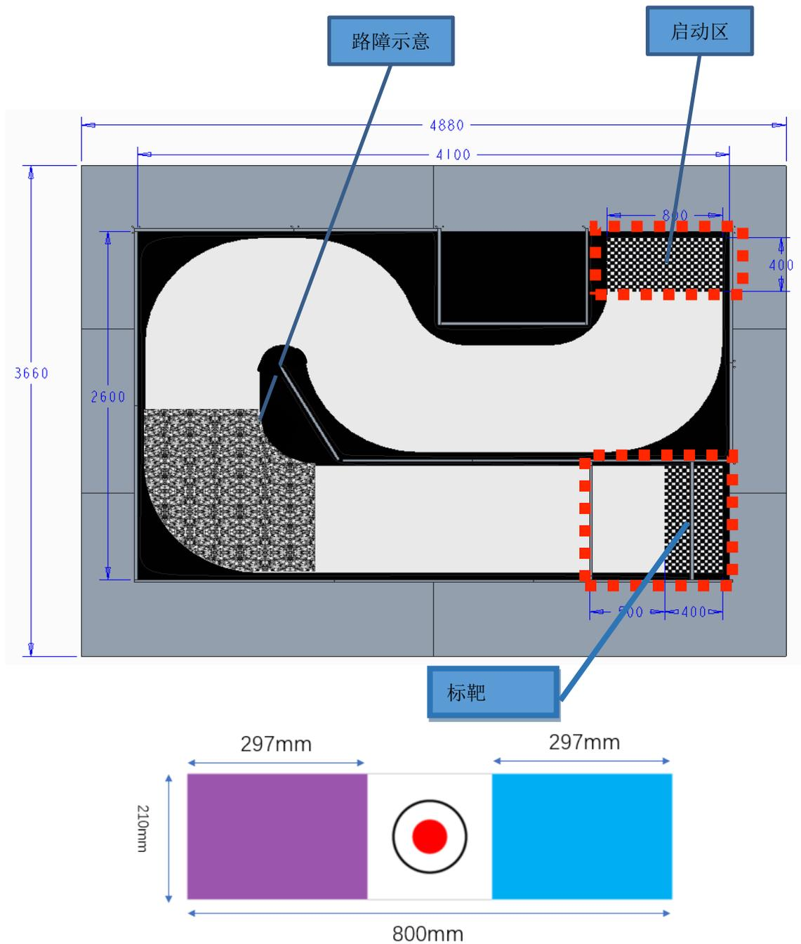
竞赛场地由木板做为底板，其上铺有软布，软布上绘有道路的图案、启动停止的区域，软布上的道路上设有路障布，路障固定在弯路位置。道路周围设有围挡架，围挡架的高度是40mm，围挡架上挂有围
